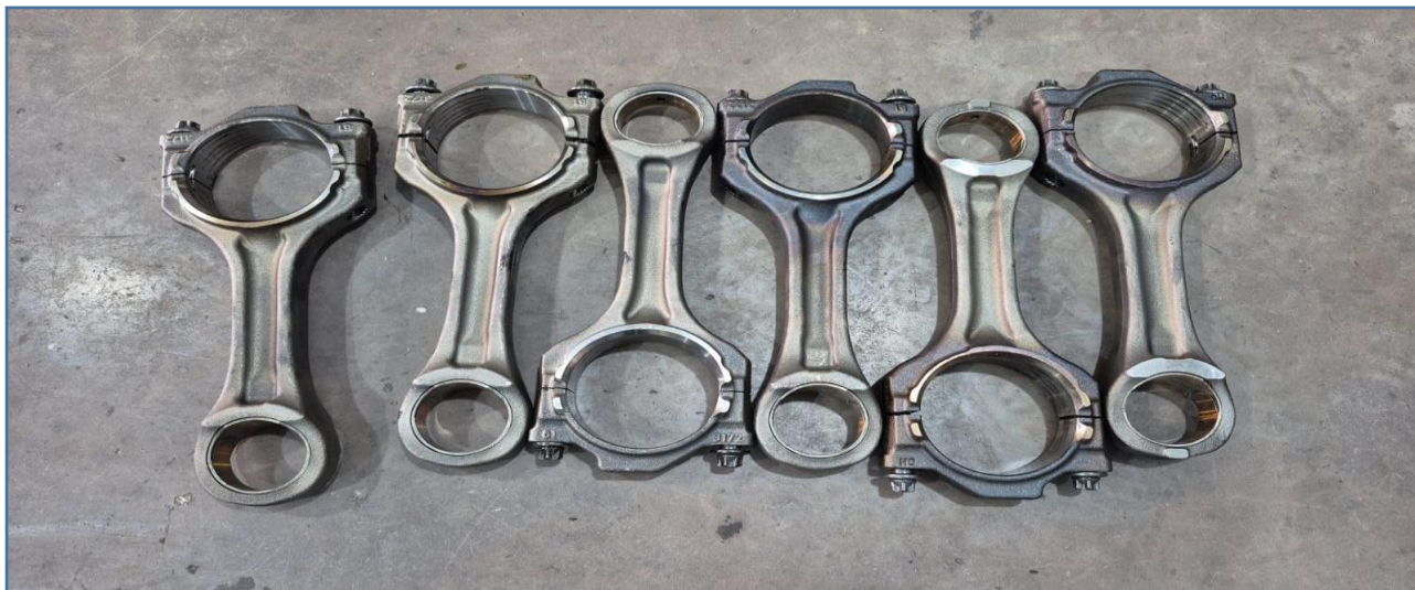
IMAGEM DETALHADA DAS BIELAS DO MOTOR, SINAIS DE SUPERAQUECIMENTO APARENTE
