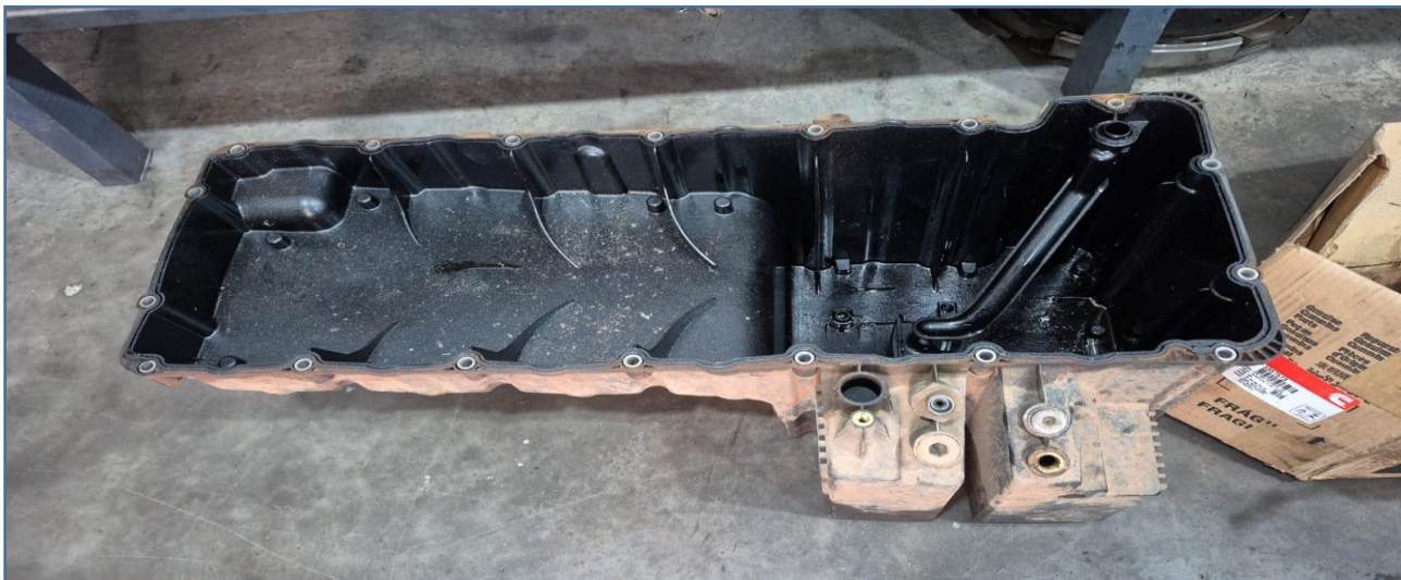
IMAGEM DETALHADA DO CÁRTER DA PARTE INTERNA
