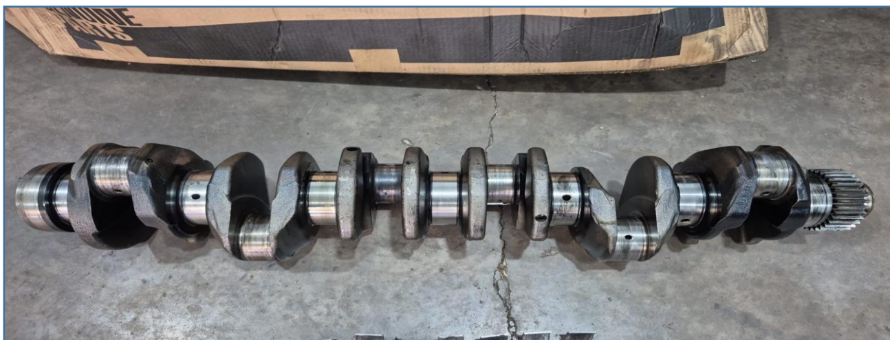
IMAGEM DETALHADA DO VIRABREQUIM QUE FICOU DANIFICADO PELA FALTA DE LUBRIFICAÇÃO (PERDEU MEDIDAS E DUREZA)
