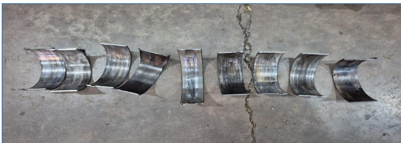
IMAGEM COM DIVERSAS BRONZINAS, ALGUMAS APRESENTAM GRANDE DESGASTE APARENTE
