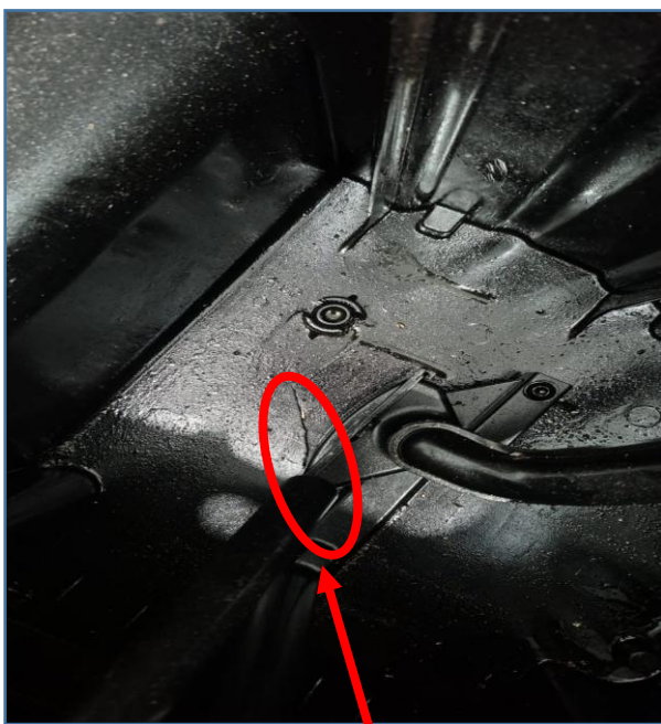
IMAGEM DETALHADA DO TRINCO DO CÁRTER INTERNAMENTE
