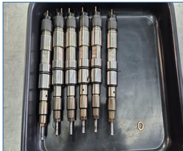
IMAGEM DO BICOS INJETORES, ESTÃO OK SEGUNDO TESTES
