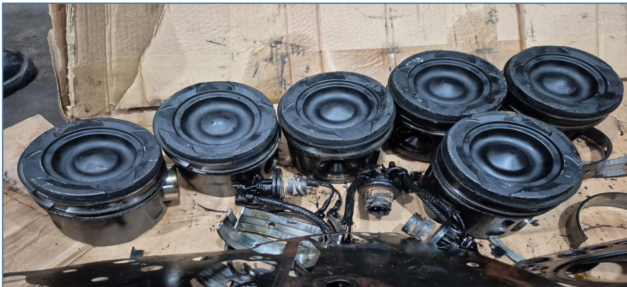
IMAGEM DETALHADA DE PISTÕES E ANÉIS JÁ DESMONTADOS, POSSUEM INÍCIO DE ENGRIPAMENTO
