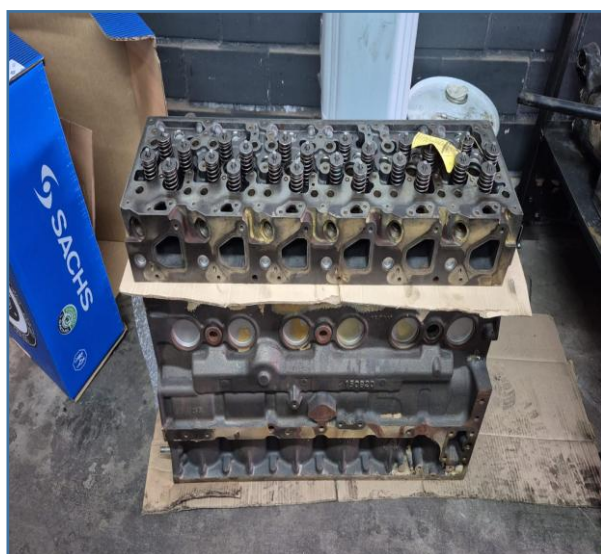
IMAGENS DO BLOCO E CABEÇOTE DO MOTOR JÁ DESMONTADOS
