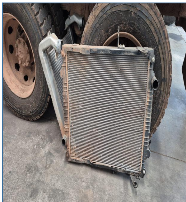
IMAGEM DO RADIADOR JÁ DESMONTADO
