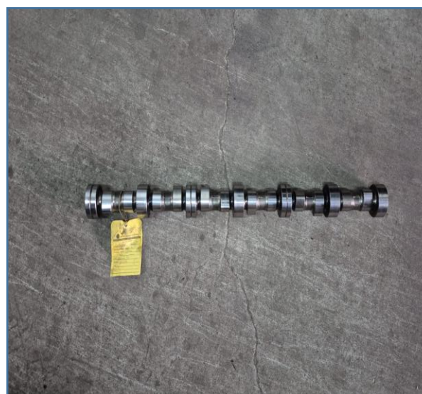
IMAGENS DO COMANDO DE VÁLVULAS, JÁ DESMONTADO
