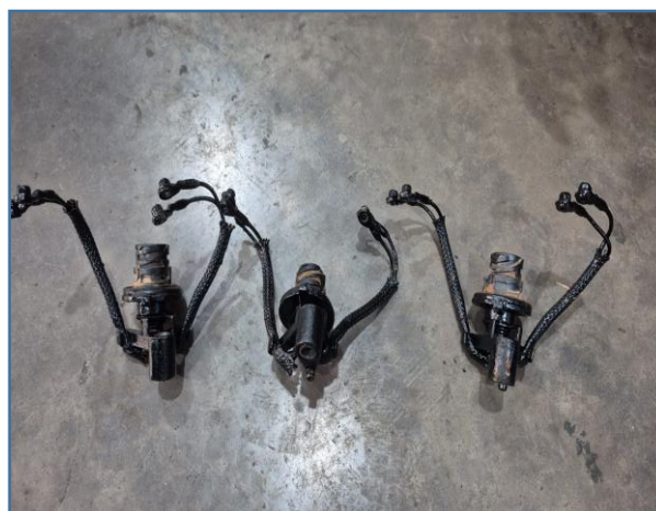
IMAGEM DE CONECTORES DOS BICOS QUE DANIFICARAM
