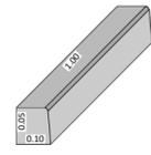
**Detalhe Meio-Fio Rebaixado S/ Escala**
