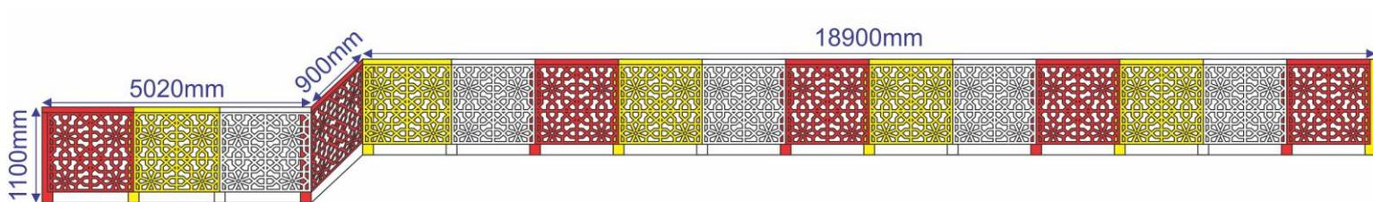
Assim, o guarda-corpo terá comprimento total de 24,82 metros (5,02m + 0,90m + 18,90m).
